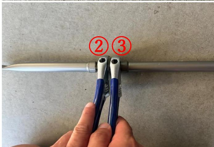
\* ウィンテックのバックステイは、通常のネジが時計回りまわして閉まりますが、逆になっているので注意してください。
