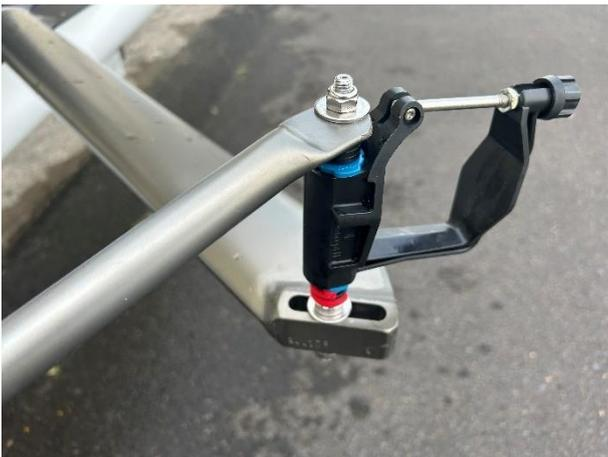
(5) ②を時計回りまわして伸ばすか、反時計回りにまわして縮めて、バックステイを適正な長さに調整を行う。
